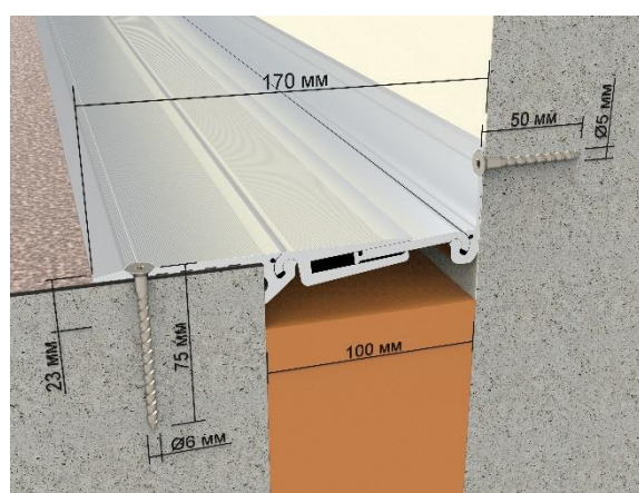
Накладной угловой вариант системы FLOOR ALU – 2 (FA-2) для шва 100 мм
